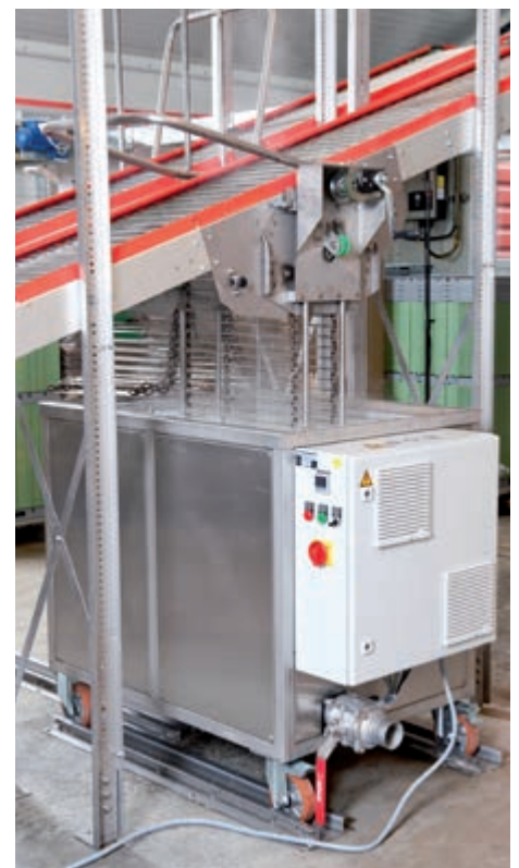
Jednostka czyszcząca: dla maksymalnej szerokości przenośnika 750 mm
