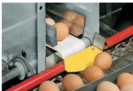
Przenoszenie jaj z taśmy wzdłużnej na taśmę poprzeczną
