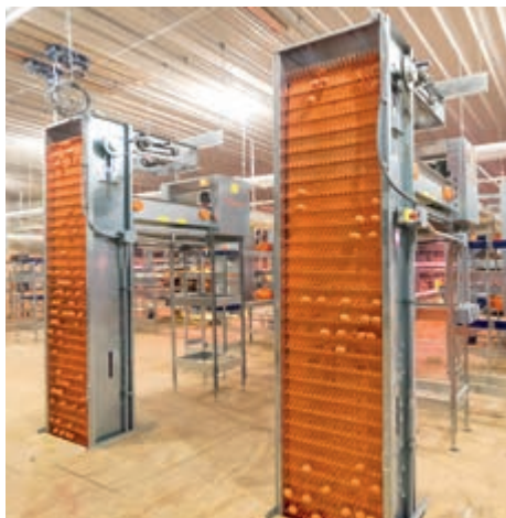
Elewator EC w budynku wielopoziomowym
