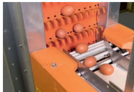
Przenoszenie jaj z taśmy wzdłużnej na przenośnik prętowy i na łańcuch elewatora
