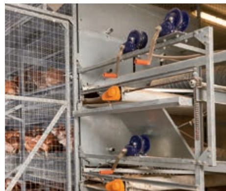
Verricelli manuali in ogni piano per apertura sportelli
