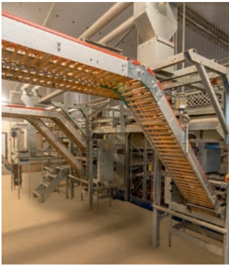
Raccolta uova longitudinale con trasportatori verticali
