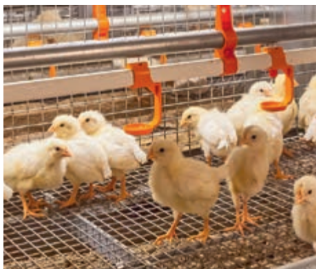
Taposó rács az alsó és középső szinteken; \frac{3}{4} \times \frac{3}{4} inch
