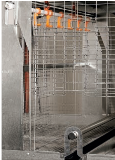
Nyitott válaszfal, állítható ülőrúd az etetővályú felett, állítható itatósor
