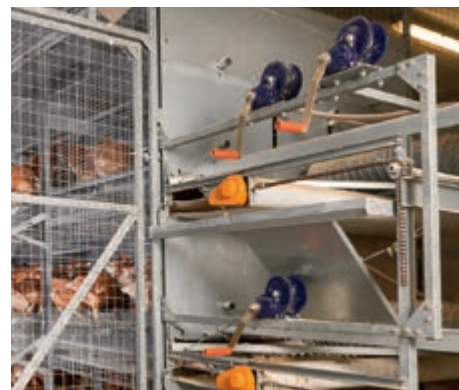
Minden szinten kézi csörlő biztosítja az ajtórács egyidejű nyitását-zárását
