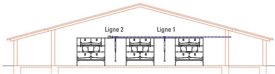
Coupe transversale du bâtiment : PickPuck avec remplissage automatique
