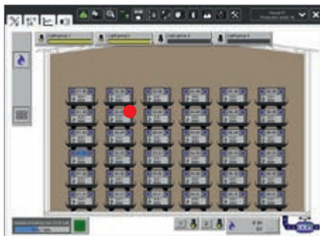
Réglage de l'éclairage et de l'approvisionnement en eau dans un poulailler, l'élément en rinçage actif est indiqué.
