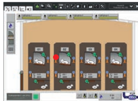
Commande de la lumière et de la distribution d'eau dans un bâtiment volière
