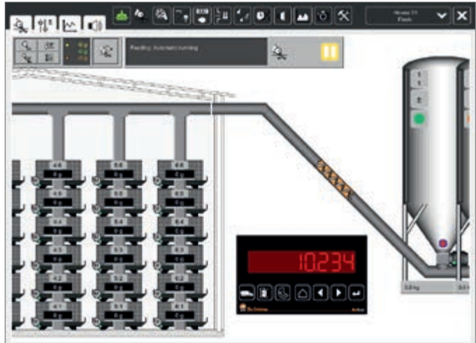
Enregistrement de la consommation d'aliments par pesée du silo avec UniScale
