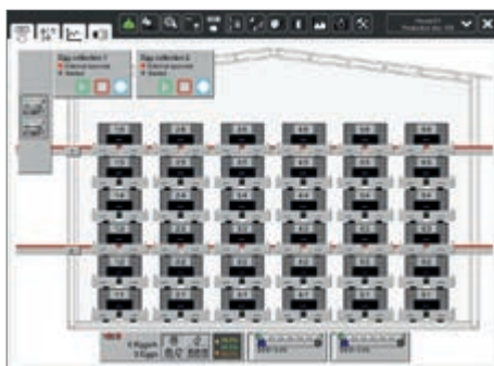
Les compteurs à œufs positionnés sur la bande longitudinale enregistrent chaque œuf
