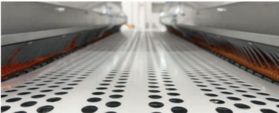
Bande longitudinale centrale des œufs de 500 mm de largeur dans NATURA Step
