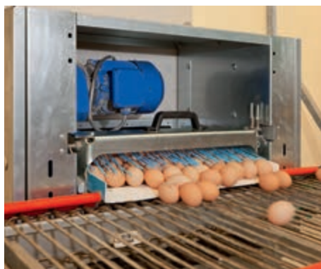
Unité de transfert avec fils de tension en acier Inox (en option)
