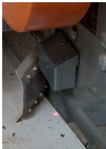
Le capteur de lumière surveille le fonctionnement du tapis
