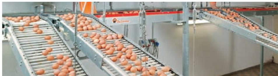
Los transportadores de varillas pueden instalarse como conexión entre el nidal y la siguiente recolección transversal. El recorrido se realiza en línea recta.
