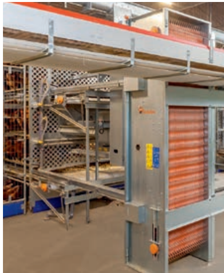
Recolección de huevos con transportador inclinado y recolección automática de huevos extraviados mediante noria
