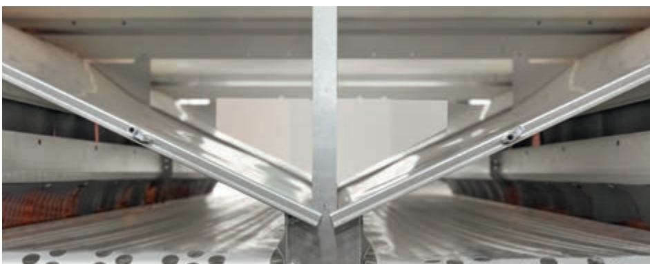
Dos cintas longitudinales separadas permiten un transporte seguro de los huevos en NATURA Step XL
