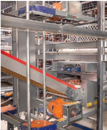
Recolección de huevos con transportador inclinado y recolección automática de huevos extraviados mediante noria
