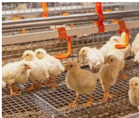
Malla de suelo en el piso inferior y central; \frac{3}{4} \times \frac{3}{4} pulgadas
