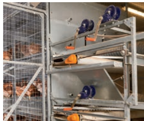
Torno manual en cada piso: apertura simultánea y fácil de la malla delantera
