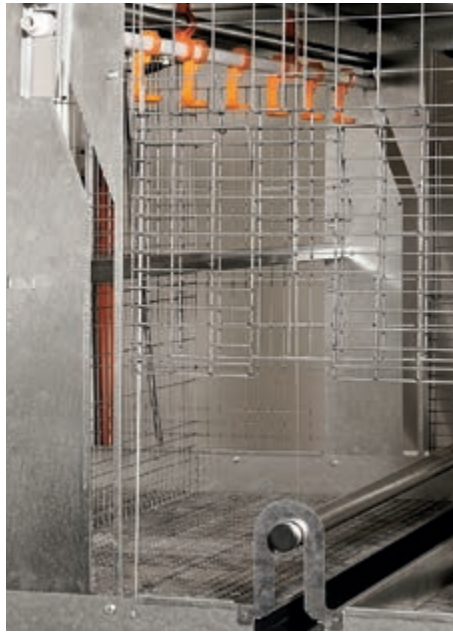
Malla de separación abierta, aseladero regulable en altura encima del comedero, línea de bebederos regulable en altura
