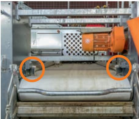
Dauerhaft sicherer gerader Lauf der Kotbänder während des Entmistens mittels AMBA
