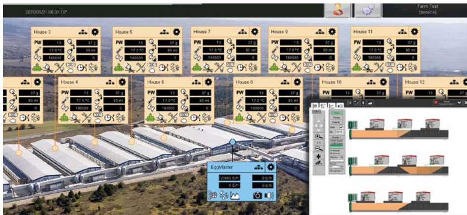
Volle Übersicht und Kontrolle auf dem Touchdisplay im Schaltschrank
