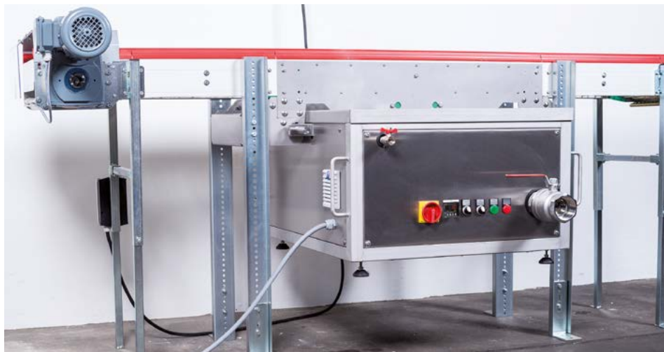
Kompakte Reinigungseinheit – benötigt weniger Platz und es ist keine Auslenkeinheit über dem Förderer nötig
