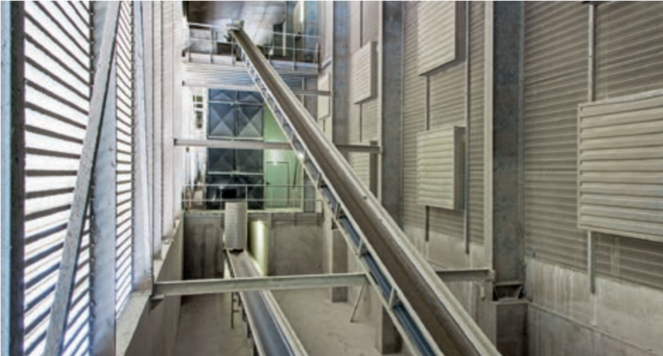
Taze gübre ile doldurulacak ve kuru gübreyi alacak taşıma bantlarına sahip OptiPlate
