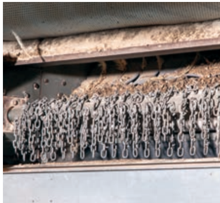
10 cm uzunluğunda zincir bağlantılı standart özellikli dilici
