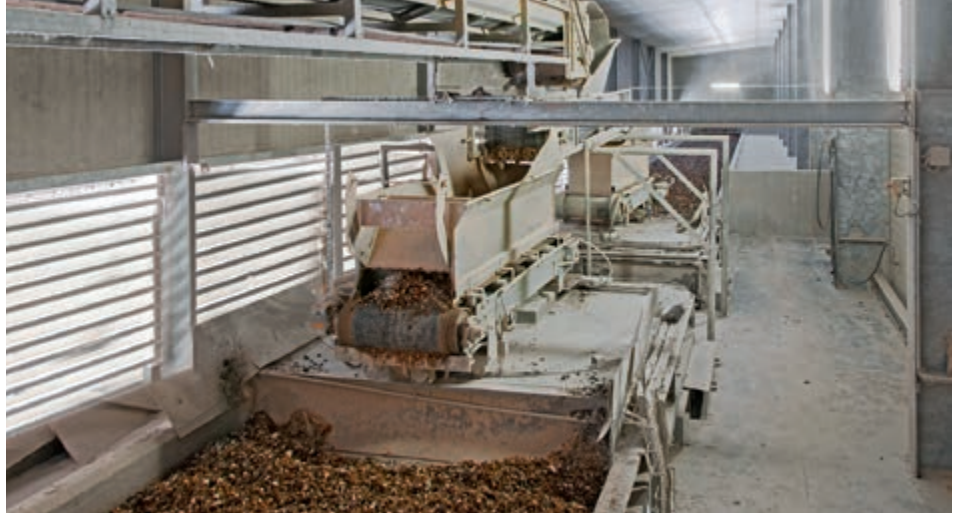
Dolum istasyonu: Öne yerleştirilen iki OptiPlate kurutucu, bir konveyör bandı ile beslenir
