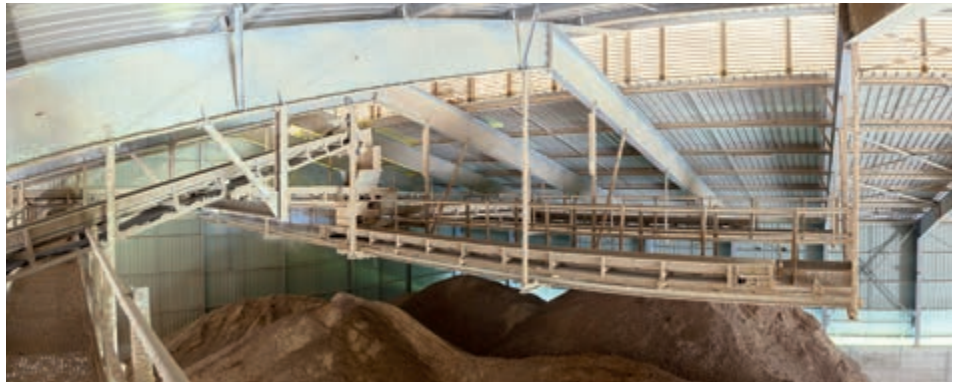
Üç taşıyıcı bant ile boylamsal olarak hareket eden bir taşıma sistemi olarak dağıtım sisteminin görünümü
