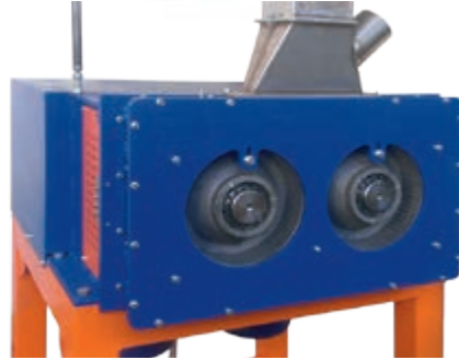
Sistemin merkez kısmı, özellikle Big Dutchman tarafından geliştirilen ekonomik peletli değirmendir
