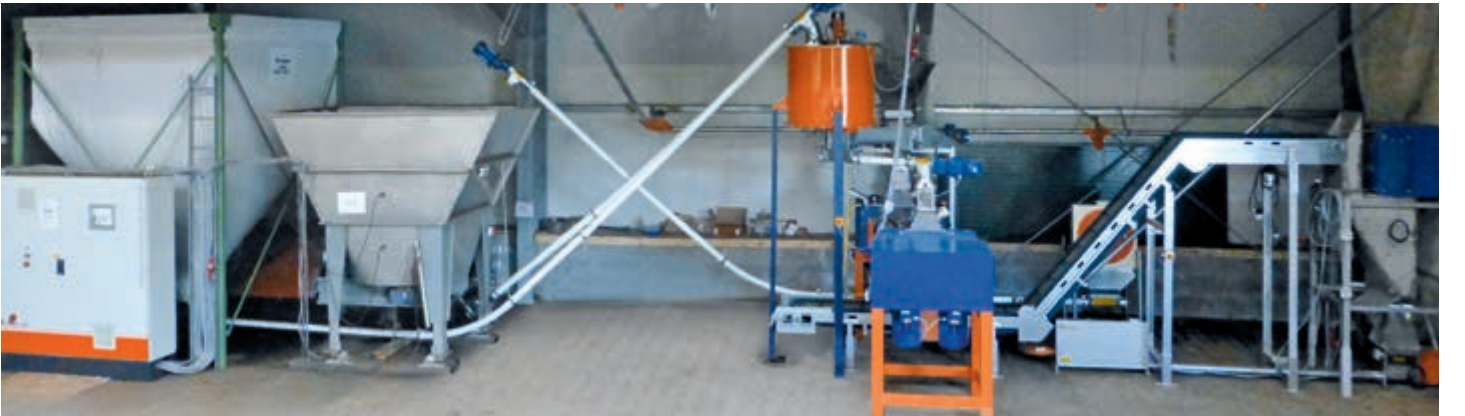
İki değirmen ve 500 kg/h kapasiteli peletleme tesisi BD PelletFix
