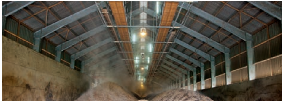
İki taşıyıcı bant ile boylamsal olarak hareket eden bir taşıma sistemi olarak dağıtım sisteminin görünümü
