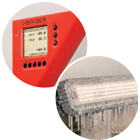
Потолочная лампа AuroraLED – испытание низкими температурами до -25°С
