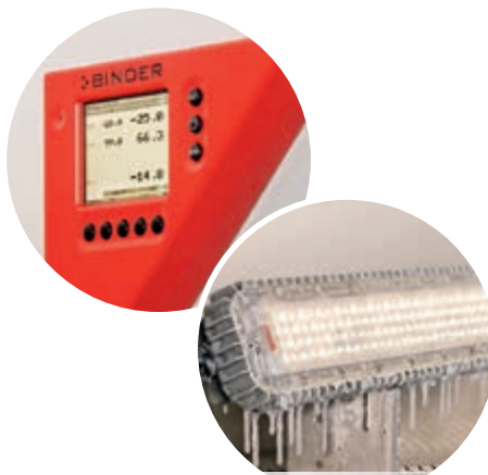
Потолочная лампа ZeusLED – испытание низкими температурами до -25°С
