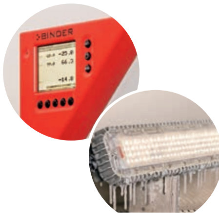
Sufitowa oprawa ZeusLED podczas testu oddziaływania niskich temperatur przy -25^{\circ}\text{C}
