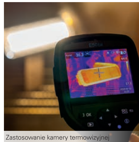
Sufitowa oprawa ZeusLED podczas testu oddziaływania niskich temperatur przy -25^{\circ}\text{C}
