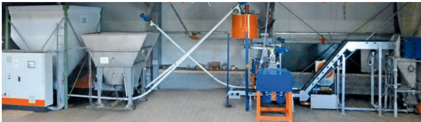
Vista di BD PelletFix con due pellettizzatori e una capacità di 500 kg/h
