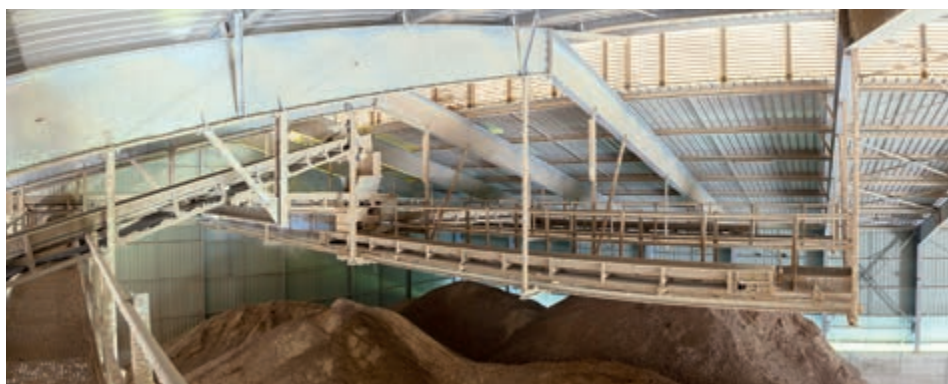
Vista di un sistema di distribuzione con sistema di trasporto che si muove longitudinalmente con tre nastri trasportatori
