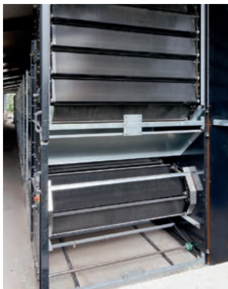
OptiPlate aperto con il raschietto
