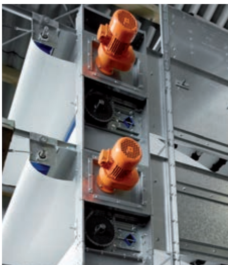
Meccanismo di trasmissione standard e coclea su ogni piano
