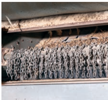
Trituratore installato con caratteristiche standard con 10cm di catene metalliche
