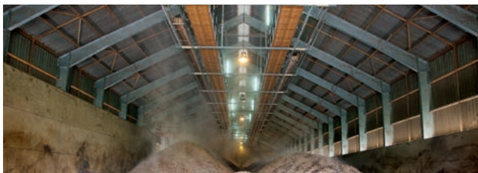
Vista di un sistema di distribuzione con sistema di trasporto che si muove longitudinalmente con due nastri trasportatori
