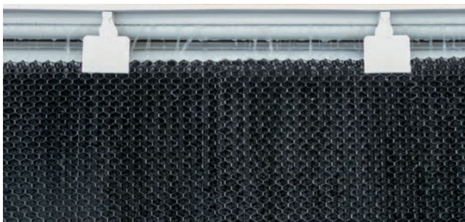
Profilo superiore con tubazione forata e deflettore per una distribuzione uniforme dell'acqua lungo i pannelli
