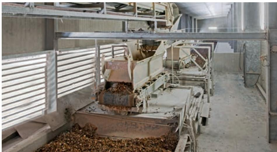
Unité de remplissage : Ici, deux OptiPlate placés à l'opposé l'un de l'autre sont approvisionnés par une bande transporteuse
