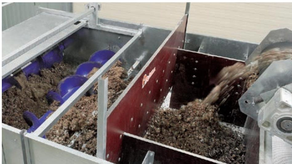
Les vis de distribution assurent l'étalement homogène des fientes sur les bandes
