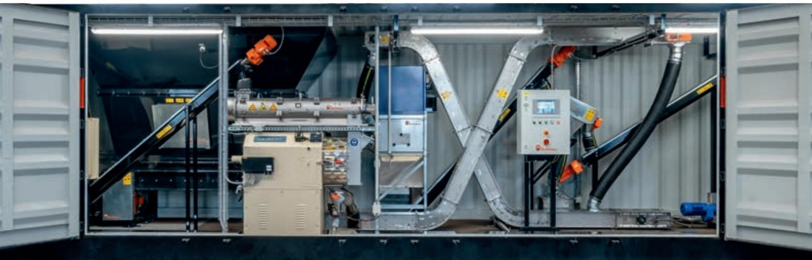
La BD PelletBox 750 est livrée prête à être connectée dans un conteneur HQ de dimensions 12192 x 2438 x 2896 mm.
