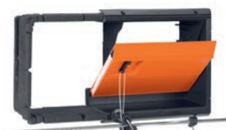
CL 1211/F Anti-Freeze – le volet à bride avec la meilleure isolation de la trappe et du cadre pour les régions très froides avec des températures de -25°C – presque pas de formation de glace sur le volet
