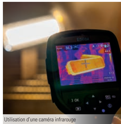
Lampe de plafond ZeusLED soumise au test de froid à -25^{\circ}\text{C}
