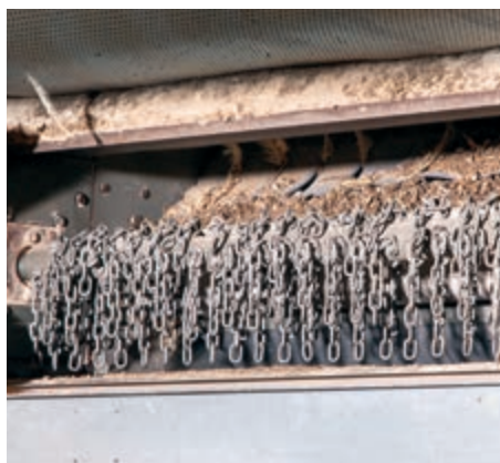
Standardmäßig integrierter Häcksler mit 10 cm langen Kettengliedern
