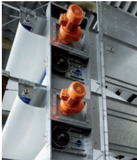
Standard-Kotbandantrieb und Schneckenumlenkung pro Etage
