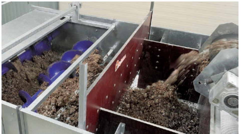
Die Verteilerschnecken sorgen für eine gleichmäßige Befüllung der Bänder
