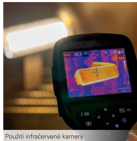
Stropní svítidlo ZeusLED testováno při teplotách -25°C
