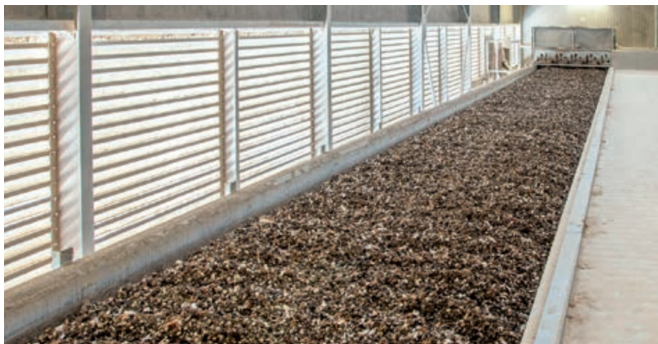
Поглед към най-горния етаж. В края има трошачка, която раздробява тора
