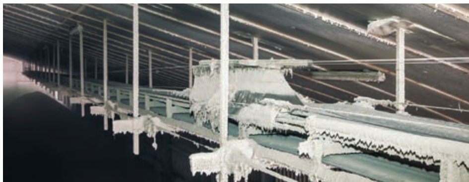
Поглед към лентата за разпределяне с помощта на стъргалка
