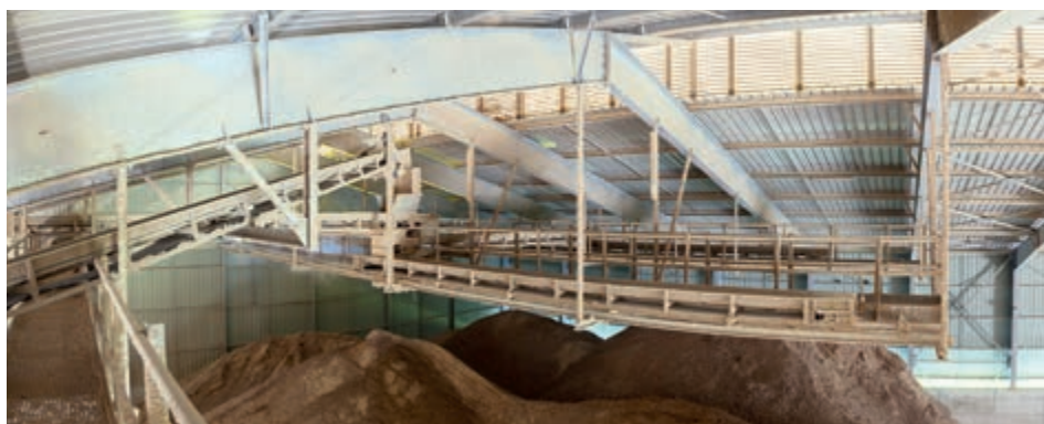
Поглед към инсталацията за разпределяне с помощта на системата за надлъжно транспортиране с 3 ленти
