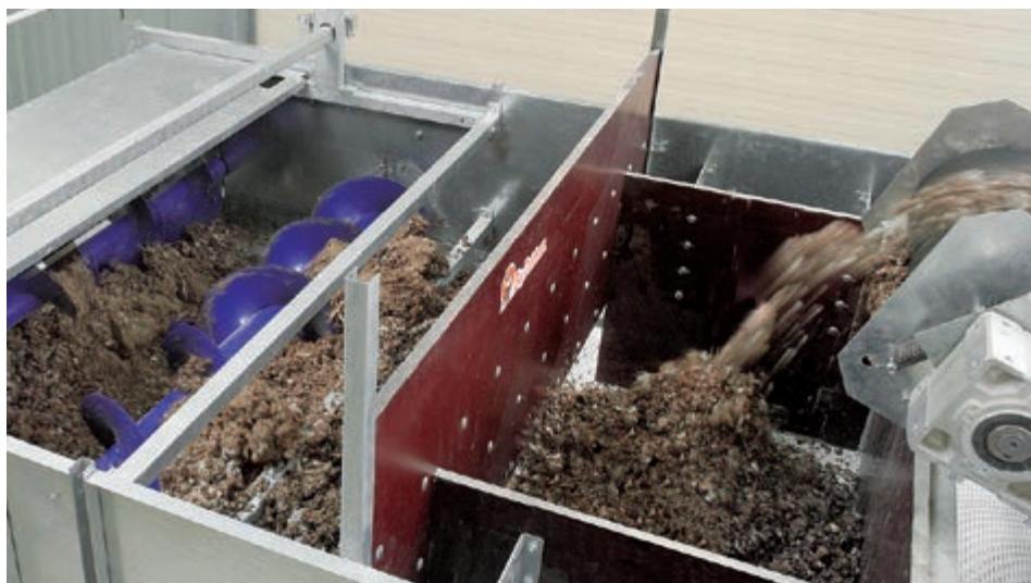
Разпределителните шнекове осигуряват равномерното разпределение на тора върху лентите
