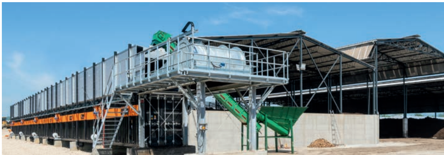
CompoLiner – вид збоку, завантаження матеріалу, перетрушувач в положенні «очікування»
