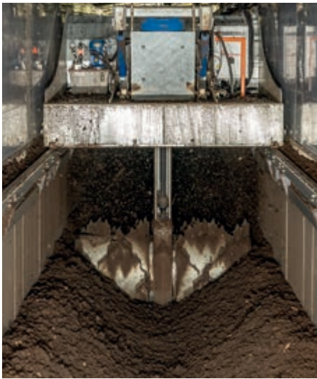
Rozgarniacz rozdrabnia i homogenizuje materiał
