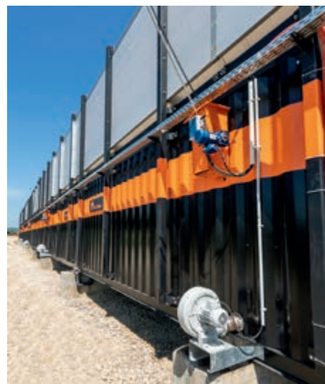
Sprężarka wtlacza świeże powietrze do kompostowanego materiału
