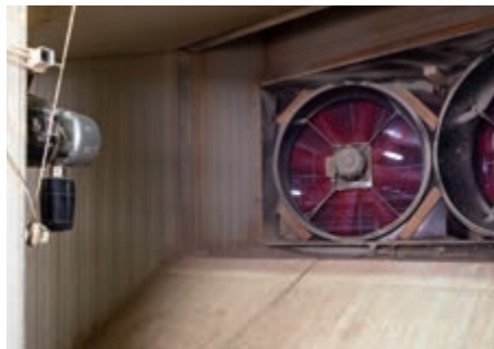
Misurazione di NH 3 nell'aria esausta (con un display separato per una prova di controllo)
