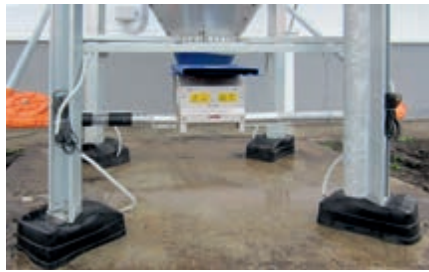
Pieds de silo protégés pour un pesage sûr en cas de conditions climatiques extrêmes
