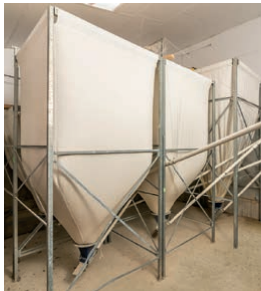
Silos de tejido Trevira para interiores
