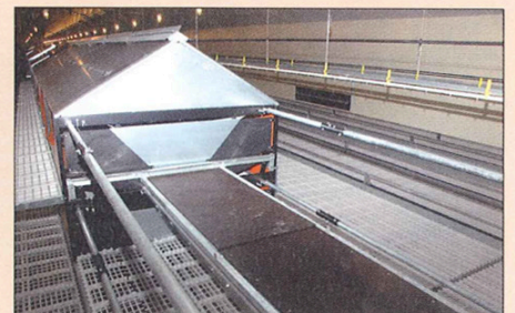
▲ 2 500 m de linéaires de perchoirs positionnés au-dessus des chaînes d'alimentation et des lignes de pipettes mais aussi entre les pondoirs.
